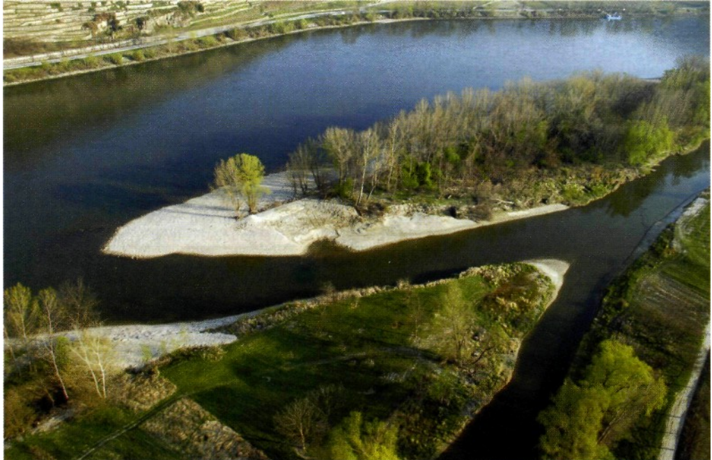
Abb. 7: Der untere Einströmbereich des neuen Nebenarmes in der Pritzenau (Life-Projekt Wachau) sorgt auch bei Niederwasser für eine kräftige Durchströmung. Bild: Foto Haslinger
